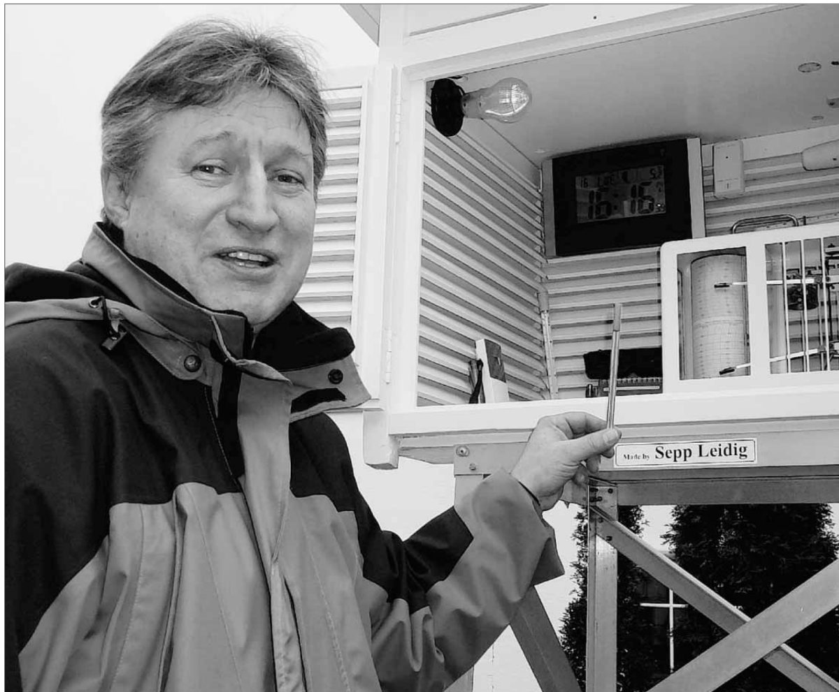
Roland Roth zeigt auf den Thermohygrographen in der Wetterhütte. Dieses Gerät misst Temperatur und Luftfeuchtigkeit gleichzeitig. SZ-Foto: Regine Reibling
